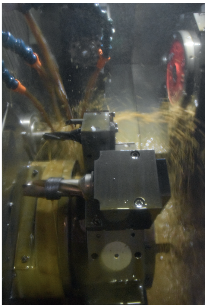
Dettaglio lavorazione di un componente tornito su un tornio a testa fissa con 3 torrette e 3 assi Y.
