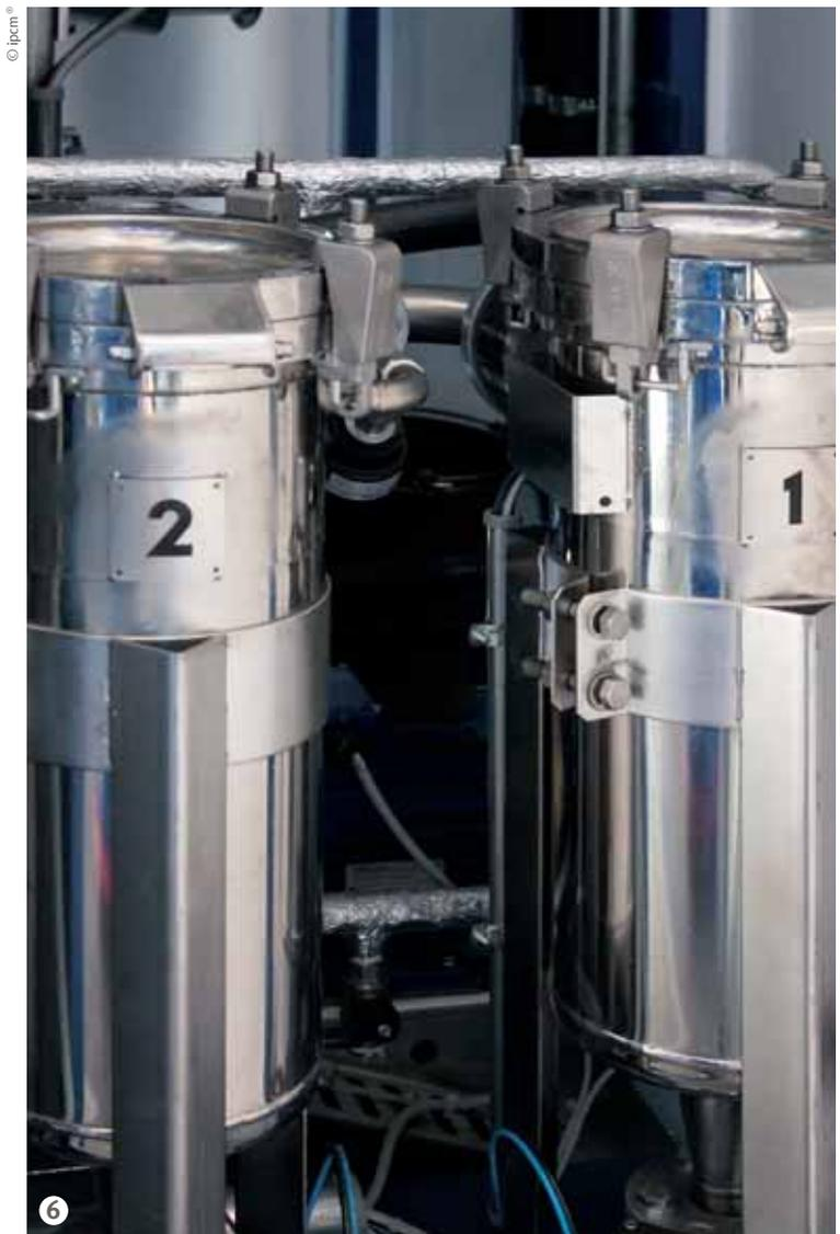
**Figura 6: Serbatoi per la raccolta del prodotto distillato.**
