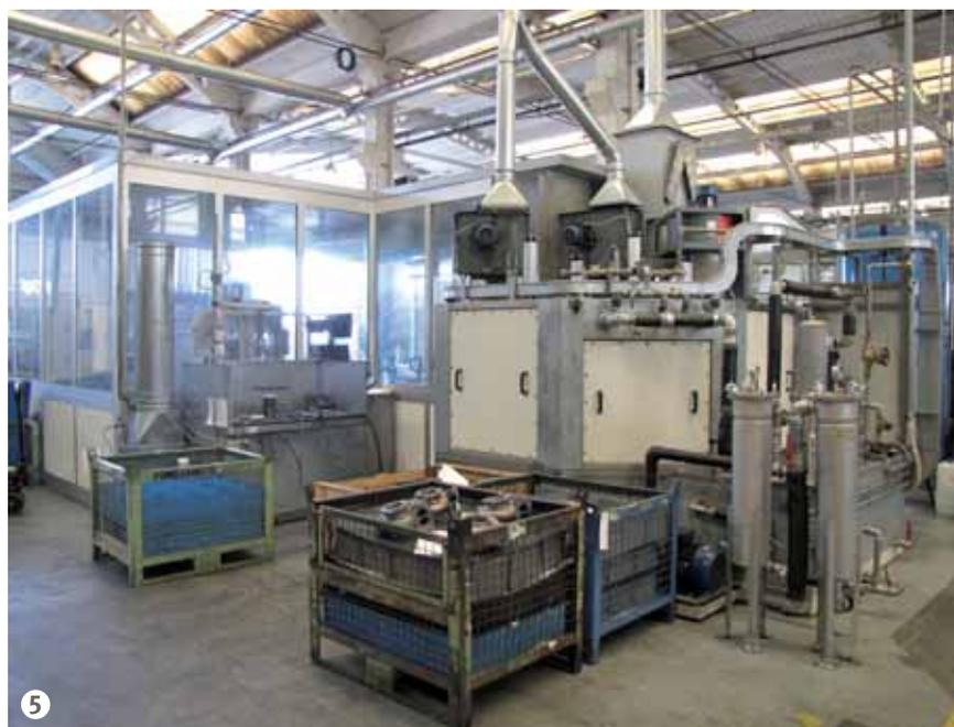
Figura 5: L’impianto di lavaggio a giostra di Dollmar Meccanica.
