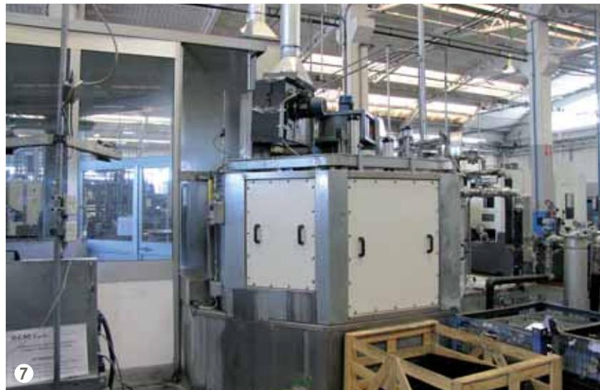
Figura 7: Il sistema di lavaggio a giostra e, sulla sinistra, la camera di prova isolata.
