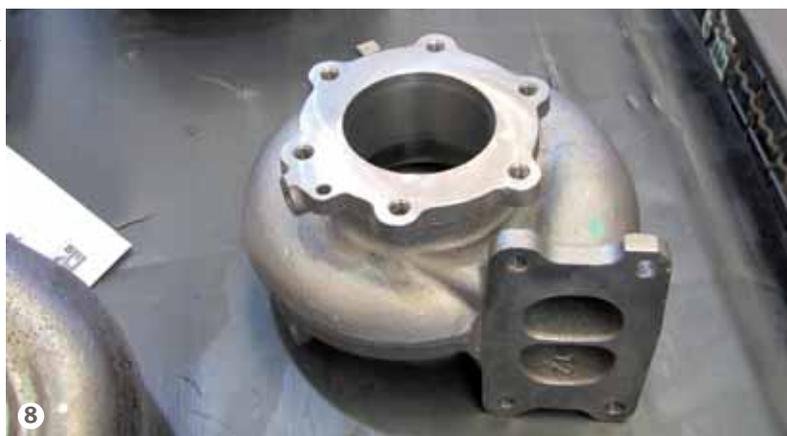
Figura 8: Una turbina in uscita dall'impianto di lavaggio in attesa della verifica visiva da parte dell'operatore.
