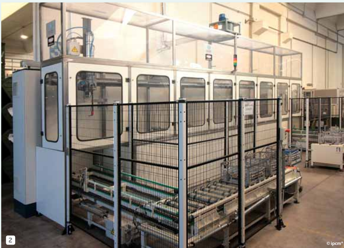
2 The two stations of the cleaning line. In the foreground, the basket loading area. Le due stazioni della linea di lavaggio. In primo piano la zona di carico dei cesti.
