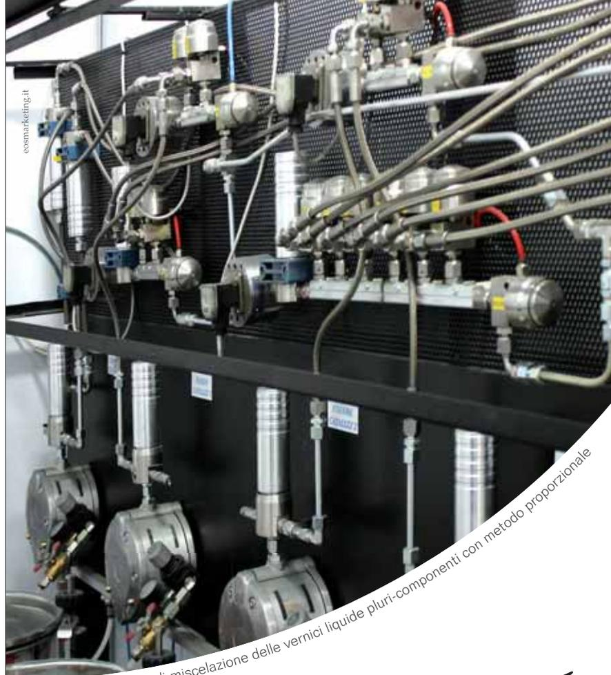
sistema automatico di miscelazione delle vernici liquide pluri-componenti con metodo proporzionale
