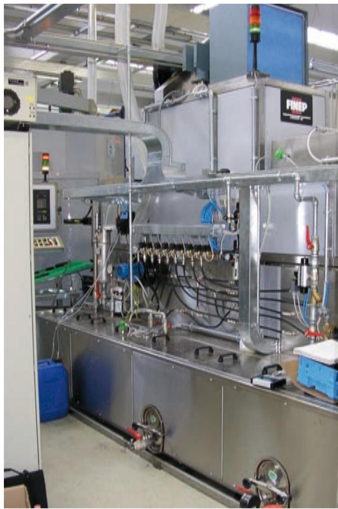
Tunnel di fosfatazione per corpi valvola in ghisa. Il tunnel è inserito in un'isola completamente automatizzata completa di lavorazioni meccaniche e verniciatura finale con processo di essiccazione mediante radiazione U.V.
