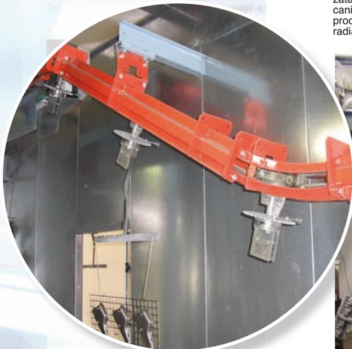
Particolare del gancio rotante del trasportatore meccanico dell'impianto di verniciatura parti di motori. Il gancio girevole è dotato di corona dentata che assicura l'esatto posizionamento del particolare durante la verniciatura robotizzata.
