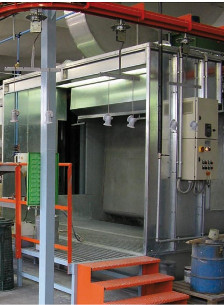
Vista prospettica di cabine in un impianto di verniciatura per parti di motori di motocicli.
