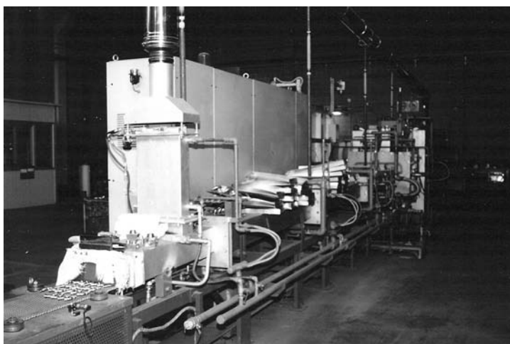
5 - Il forno di saldobrasatura, lungo 18 metri.
