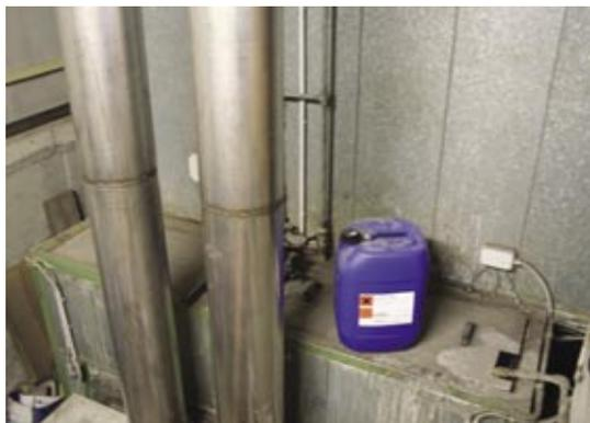
7 - Le due vasche sottostanti la cabina di lavaggio, dalle quali le due pompe immettono nella cabina stessa la soluzione di sgrassaggio e fosfatazione e l'acqua di risciacquo
