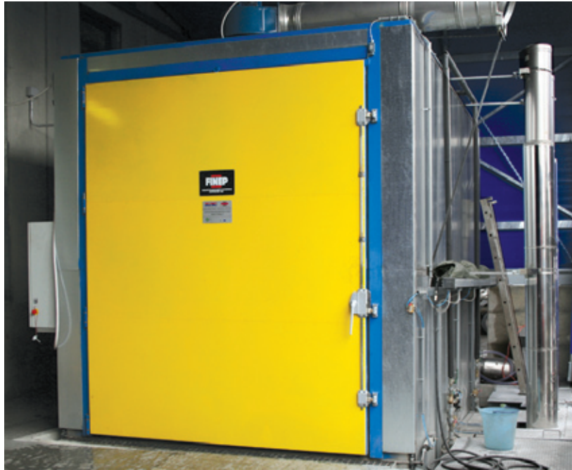
2 - L'impianto automatico di lavaggio e pretrattamento.
