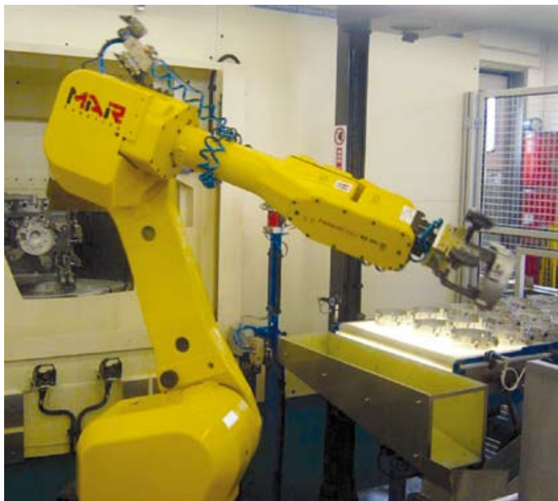
7 - Il robot “fuori impianto” che porta i pezzi alla lavatrice.
