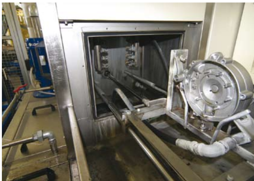
8 - Il manipolatore posiziona il pezzo sul porta-pezzo solidale al cassetto della lavatrice.
