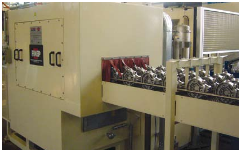
10 - L'uscita dei pezzi perfettamente lavati ed asciugati dal forno.
