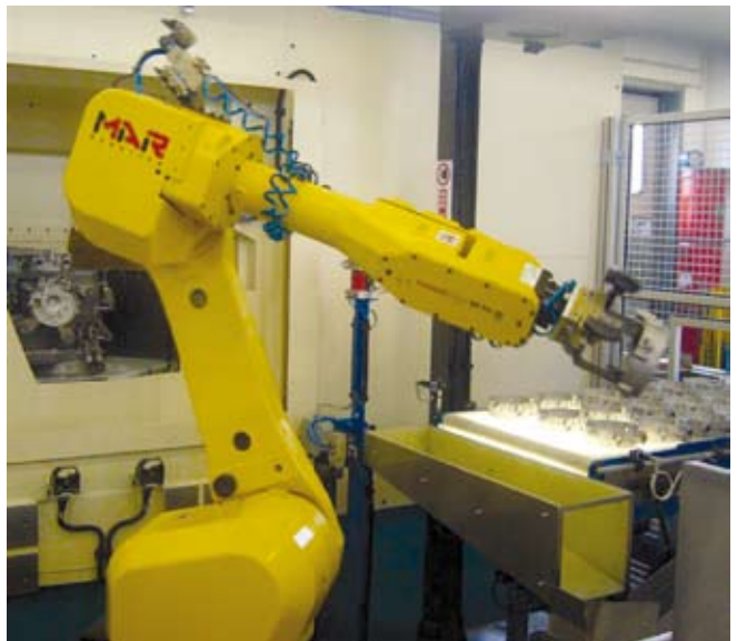
7 – El robot “fuera instalación” que lleva las piezas a la lavadora.
