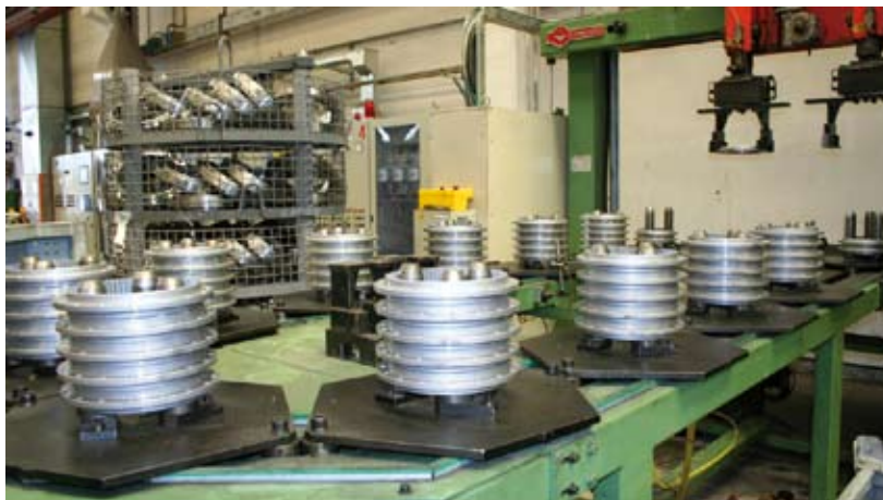
2 - Alcuni esemplari di riduttori in fase di montaggio finale.
