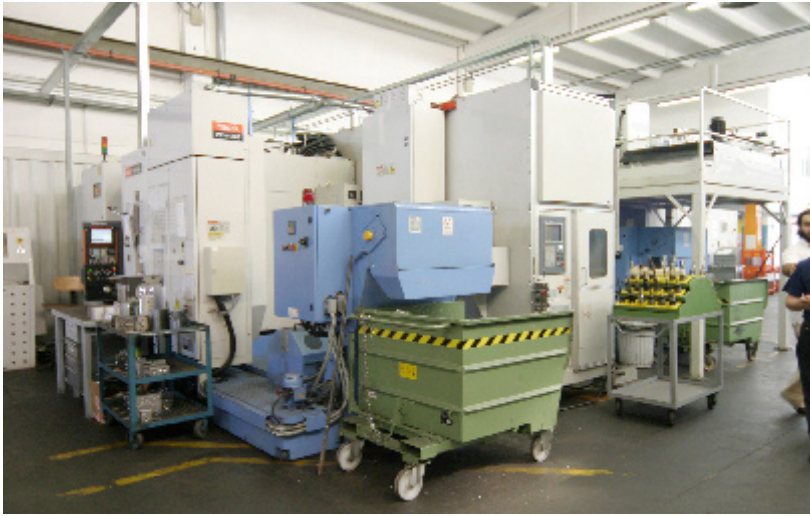
2 - Una vista del reparto produzione: è visibile un centro di lavoro a controllo numerico, in funzione 24 ore su 24.
