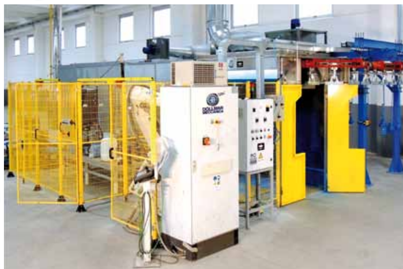
Impianto automatico di verniciatura completo di robot antropomorfo ad autoapprendimento
