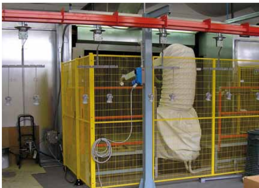
Impianto di verniciatura in continuo completo di tunnel di pretrattamento e robot antropomorfo
