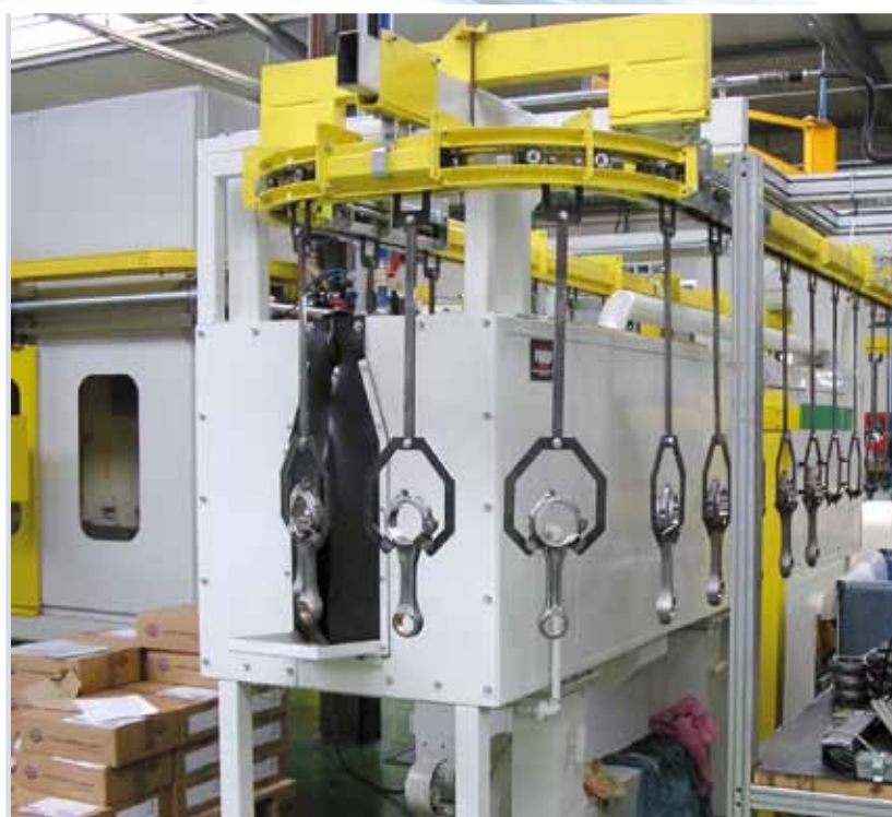
Impianto di lavaggio a spruzzo per bielle con trasportatore aereo e carico/scarico mediante robot antropomorfo
