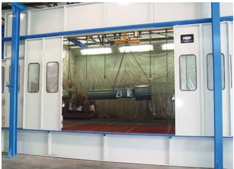
Impianto di verniciatura per grossi manufatti con nastro trasportatore aereo
