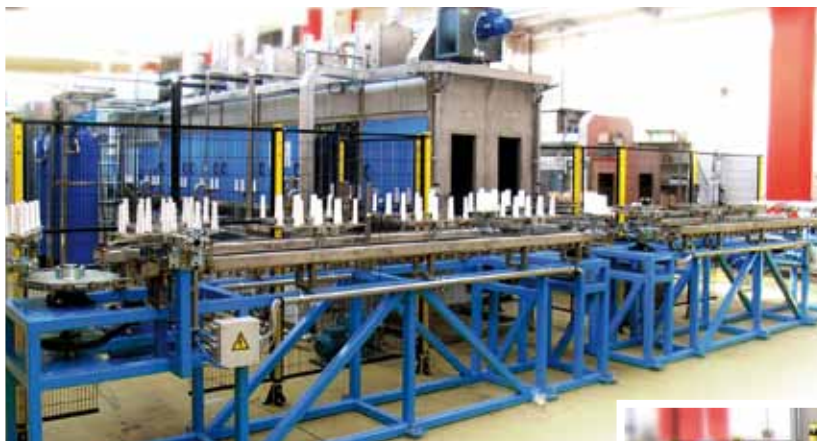
Tunnel di pretrattamento con trasportatore rovesciato per dischi freno
