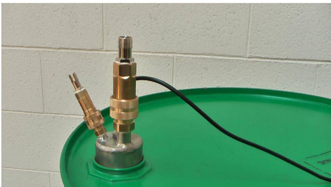
Elemento realizzato in acciaio inox, con galleggiante di troppo pieno e valvola di sfiato, che applicato al fusto standard da 200 l. e tramite un attacco rapido, consente di operare a ciclo chiuso durante le operazioni di svuotamento del solvente esausto.
